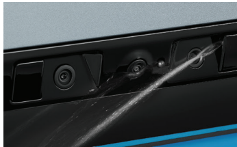
3층 카메라 클리닝 시스템: 후방 모니터, 디지털 센터 미러, 빌트인 캠 2
