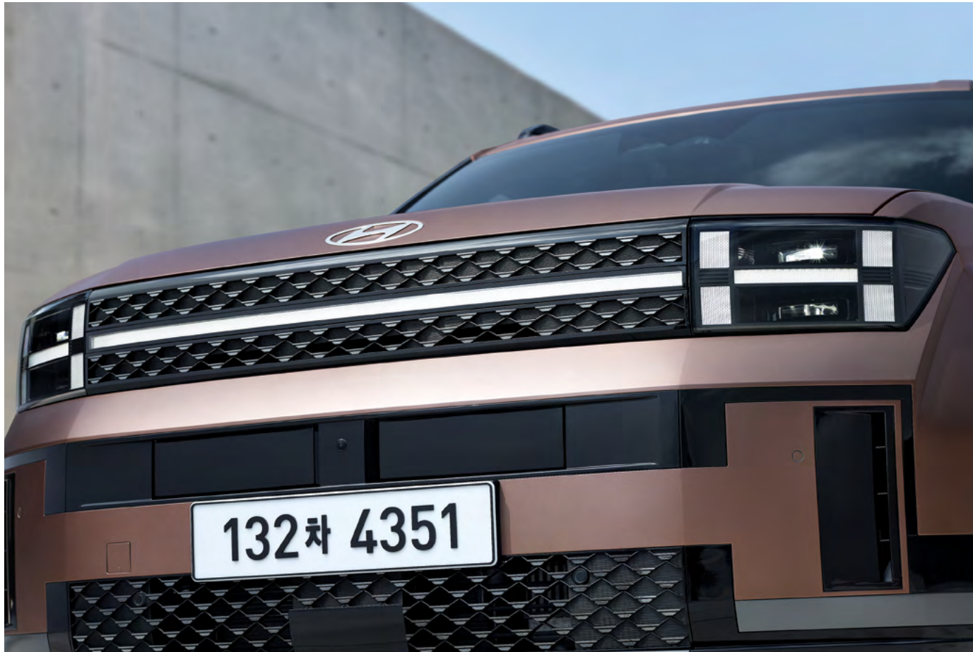
수평형 LED 램프(포지셔닝램프) & Full LED 헤드램프(프로젝션 타입)
