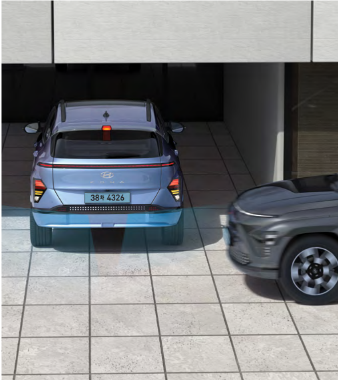
후방 교차 충돌방지 보조 저속 후진 시 좌/우측에서 다가오는 차량과의 충돌 위험이 감지되면 운전자에게 경고하고, 경고 후에도 충돌 위험이 높아지면 자동으로 제동을 도와줍니다.
